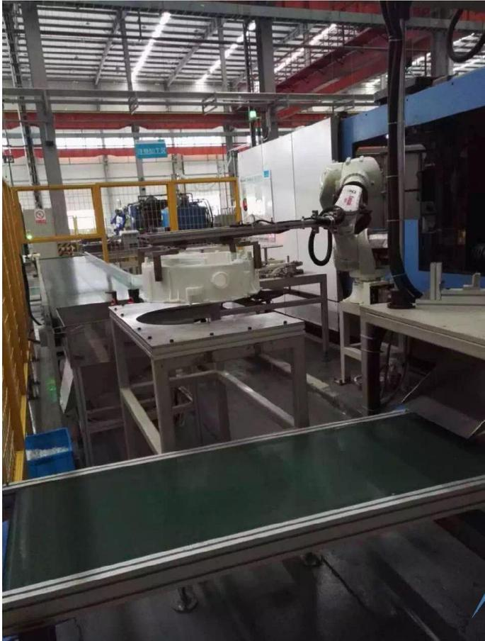
注塑机安装机器人完成取件、镶件、剪切交口等功能
